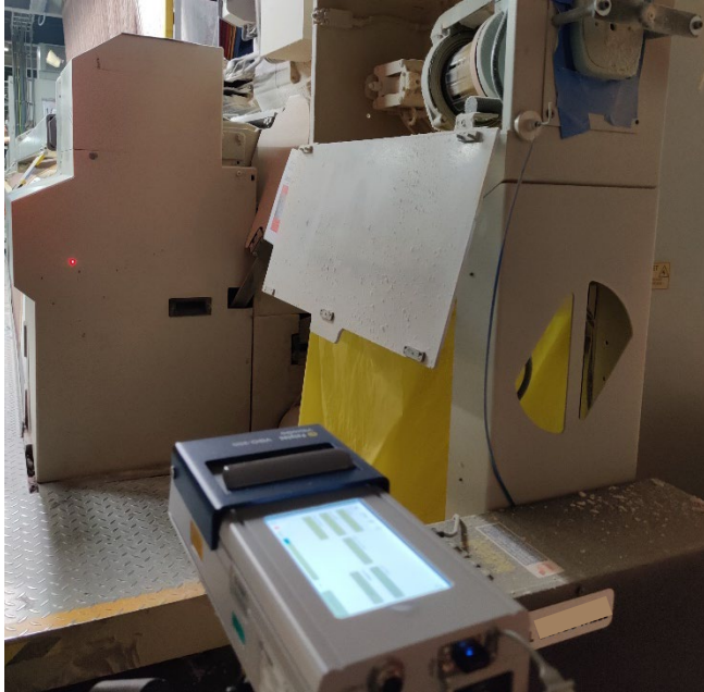
Afbeelding 6. Contactloze trillingsmeting van weefmachine met behulp van Polytec laser Doppler vibrometer
